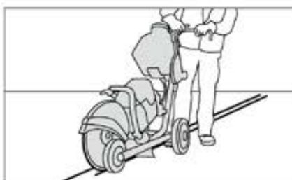
Řezání na vodorovných plochách (drážky).
