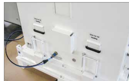
Parotěsný kontejner při zkoušce těsnosti přetlakem
