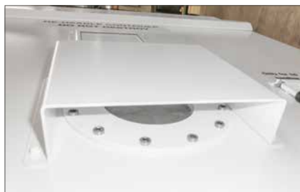
Bezpečnostní prvek - pojistný disk: ochrana před náhlým poklesem tlaku
