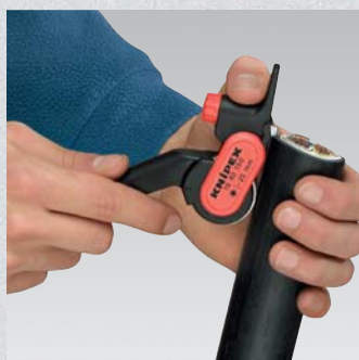
Nasazení nářadí pro odstřížení v podélném směru
