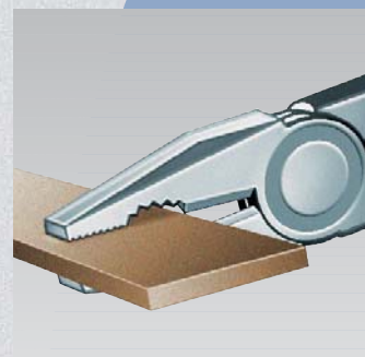
Zóna pro uchopení plochého materiálu
